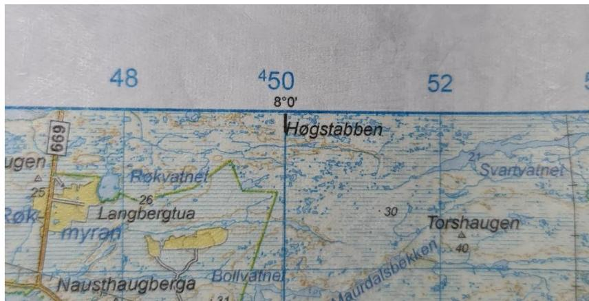
Abb 2: Gauss-Krüger-Gitter und Gradnetz
